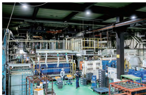
西日本最大の自動装飾クロムめっき装置
