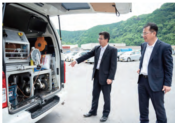
自走式のテレビカメラで配管内を検査する車両
